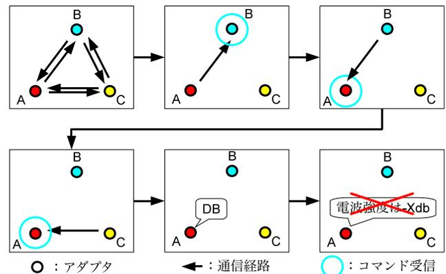
図 5.1: 誤った電波強度取得の例
