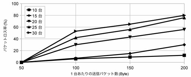
図 4.2: パケット衝突実験の結果グラフ
