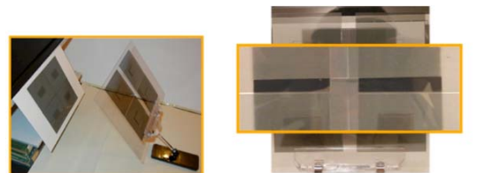
2枚の偏光板の配置 頭部位置が上にずれた場合の見え方
