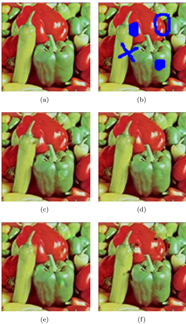
図 7: 非周期的パターン画像の修復: (a) 元画像, (b) マスク画像, (c) 提案手法 ( \lambda_1=0, \lambda_2=1, b=4 ), (d) 提案手法 ( \lambda_1=1, \lambda_2=1, b=4 ), (e) 文献 [1, 2] の手法, (f) 文献 [6] の手法
