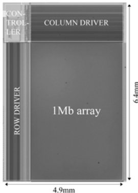
図4 1Mb NOSRAM ダイ写真
