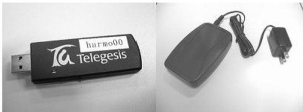
図1 本研究で用いたZigBeeエンドデバイス(左)・ZigBeeルータ
