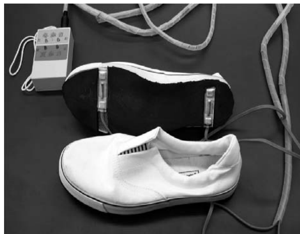
図1 靴底にテープスイッチと硬質スポンジを貼付した歩行練習靴
