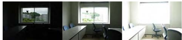
図 2: HDR 画像合成に用いる露出画像
