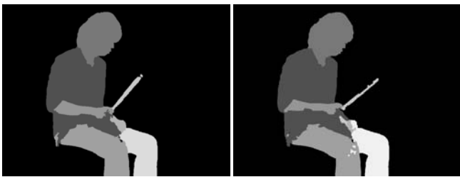
図 2: 領域拡張法を用いたときの追跡結果:(左) 追跡成功例 (10 フレーム目), (右) 追跡失敗例 (38 フレーム目)
