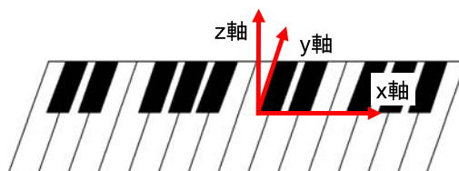
図1: 鍵盤座標系。鍵盤座標系は鍵盤の中央八に原点を、鍵盤の平面上に x 軸, y 軸を、鍵盤平面と鉛直の方向に z 軸を定める。
