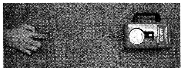
図6 静摩擦係数の測定
