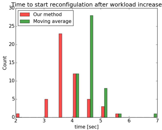
図 4 リクエスト増加後から構成変更を行うまでの時間分布
