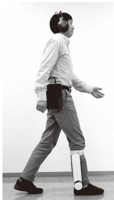
図-2 GaitEcho: 聴覚フィードバックによる歩行リハビリシステム 5)
