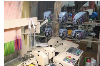
図3 6色の緯糸がセットできるジャカード織機
