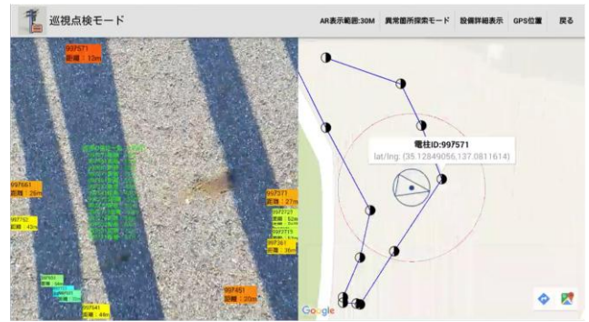
図 6 電柱ナビゲーション機能の動作例
