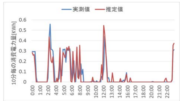
図 11 電力推定結果(IH 機器) Figure 11 Result of power usage estimation (IH heater)
