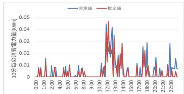
図 12 電力推定結果(電子レンジ) Figure 12 Result of power usage estimation (microwave oven)
