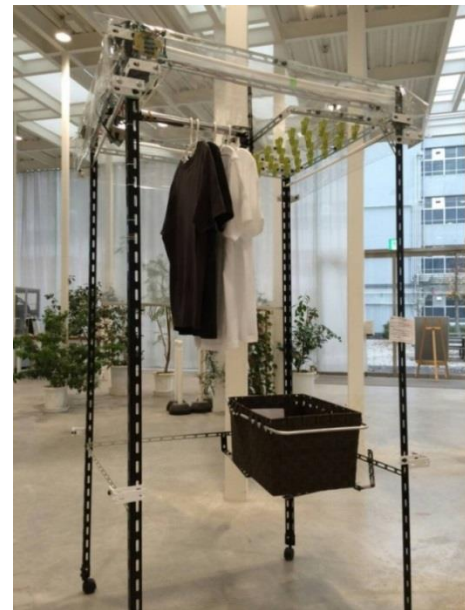
図 2 「洗濯物取り込みロボット」の試作 Figure 2 Prototype of "laundry uptake robot".
