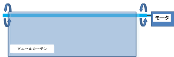
図 7 カーテン巻き下げ・巻き上げ機構の動作図
