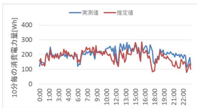
図 19 成分分離の検証結果(冷凍機) Figure 19 Separation test result (chilling unit)
