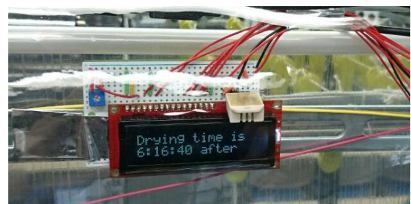
図 9 乾燥時間を表示する LCD
