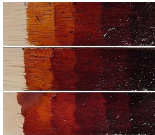
図9 ガラス蛍光体粉末混合液を塗布したサンプル (上段:10%, 中段:5%, 下段:1%)
