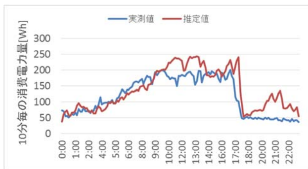
図 18 成分分離の検証結果(空調機) Figure 18 Separation test result (air-conditioner)
