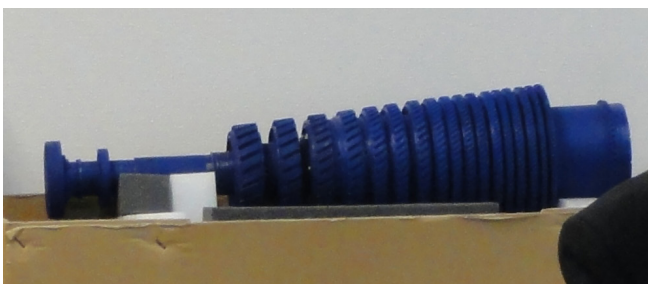
図1 3Dプリンタで作ったガスタービン模型
