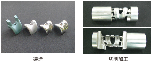
図3 従来の加工法による人工膝関節の例
