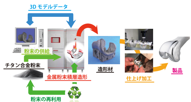
図4 電子ビーム金属積層造形
