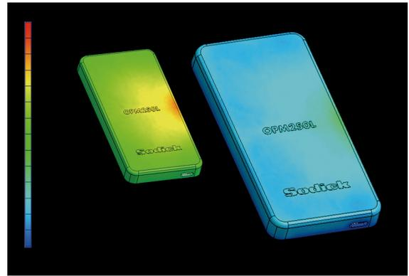
図9 樹脂温度シミュレーション比較(左:従来, 右:3次元配管)
