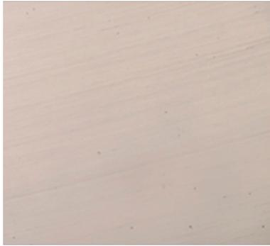
図4 マルエージング鋼造形物のミガキ面
