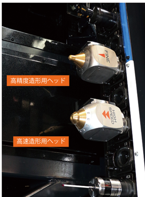
図 9 自動交換可能な造形用 (AM) ヘッド
