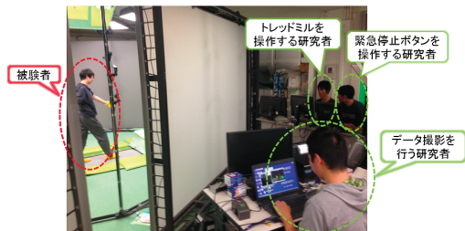
図 1 OU-ISIR Treadmill dataset [6] のデータ収集の様子。データ収集には 3 人の操作者が必要となる。
