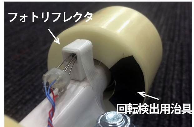
図 7 非接触反射型フォトリフレクタと回転検出治具
