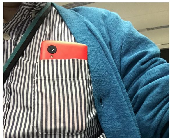
図 3 スマートフォンを利用した作業者視点映像の撮影方法
