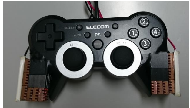
図 4：ゲームコントローラに装着したペルチェ素子
