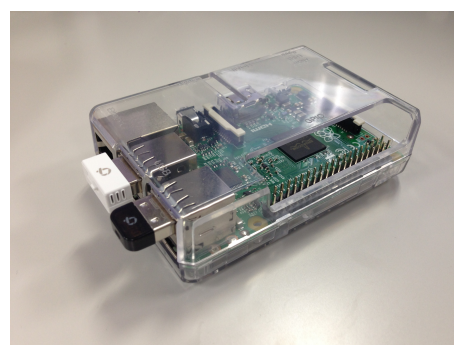
図3 Raspberry Pi を利用した iBeacon 受信機
