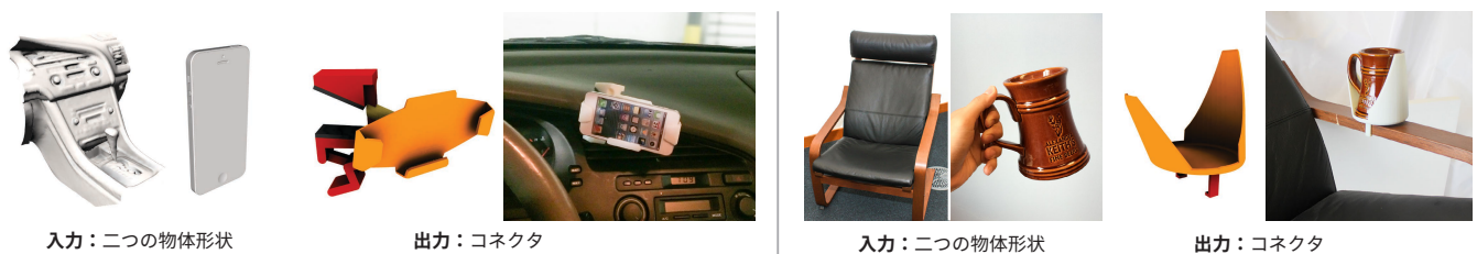
図1 AutoConnect によって生成されたコネクタの例。(a) 車のダッシュボードにスマートフォンを取り付けるためのコネクタ。(b) チェアの腕の部分にマグを置いておくためのコネクタ。©Authors
