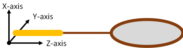
図 3 ラケットと加速度センサ軸の対応 Figure 3 Racket and acceleration axis
