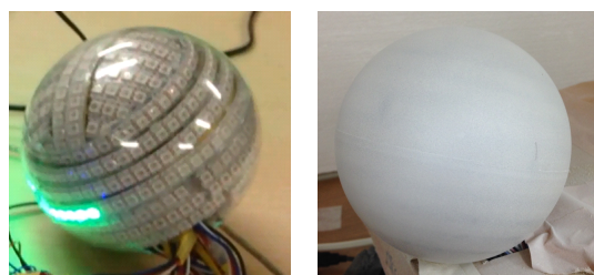
図 1 球状 LED ディスプレイの外観
