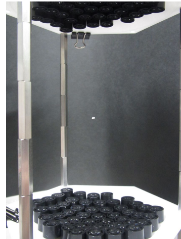
図 9 対向した振動子アレイによる音響浮揚．
