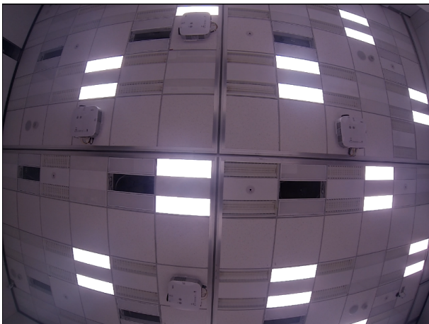
図 10 色グラデーションパターン最高調光率から最小調光率までの変化幅 10 % の点灯の様子
