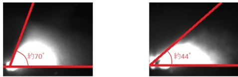
(a) 指向角35°LEDの照射角度 (b) 指向角22°LEDの照射角度
