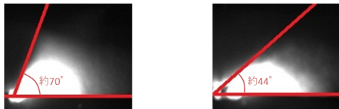
(a) 指向角35°LEDの照射角度 (b) 指向角22°LEDの照射角度
