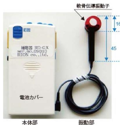
図 1 軟骨伝導補聴器初代試作機（HD-GX）
