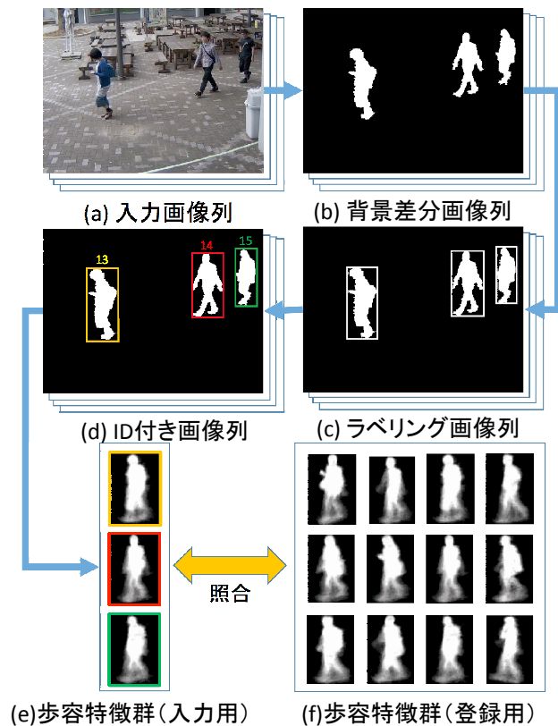
図 6 複数人物シーンに対する歩容認証のベースライン手法の概要
