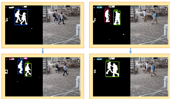
図 8 歩容特徴の抽出失敗例 (右: すれちがいの失敗例, 左: 並んで歩くことによる失敗例)
