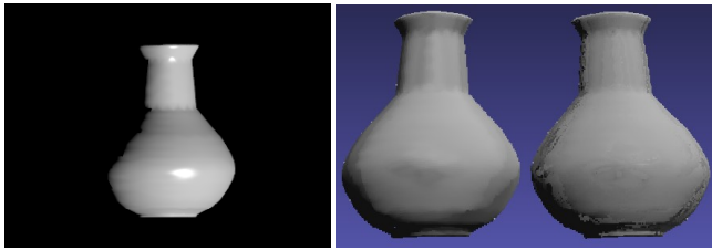
図 3 入力画像 図 4 復元された形状. 左:通常の照度差ステレオ法. 右:本手法.
