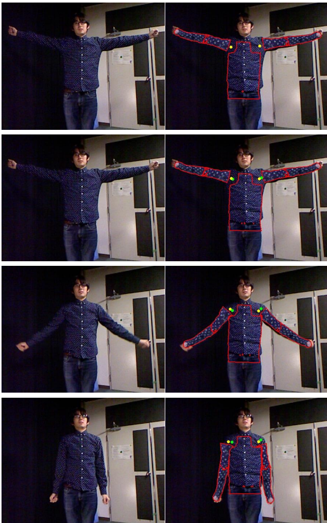
図 6 肩関節推定実験-入力画像 (左) と推定の様子 (右)
