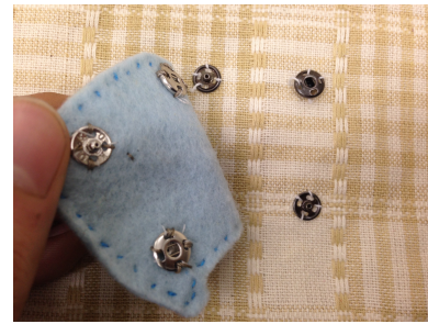
図3 布スイッチの貼り付け方
