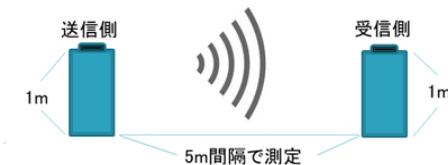
図 4. RSSI と距離測位実験のデバイス配置図
