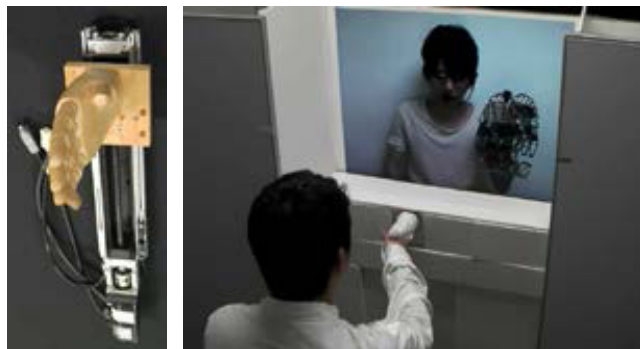
図 2 予備実験で使用したロボットハンド
