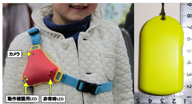
図 3 おにぎり型デバイス (左), 親用デバイス (右) Fig. 3 Onigiri device (left), Device for parent (right).
