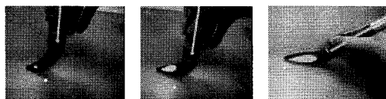
図 6 しなり方向に応じたフットプリントの回転としなり量・筆型デバイスの傾きに応じた変形
