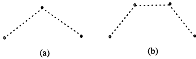
図 3 多自由度回転関節の潜在ベクトル拘束グラフ (a) 2自由度回転関節 (b) 3自由度回転関節
