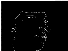
図 5 Y 方向 Sobel フィルタを適用後二値化を適用
