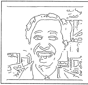
図 18 F_{edge} を用いて局所ごとに決定されたスケールによるエッジ抽出結果
