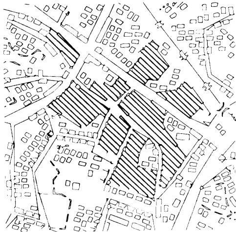
図 11 道路地図上ハッチングの認識結果 Fig. 11 Recognition result of hatching in map drawing.
