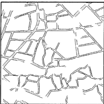
図 13 地図要素識別部にて抽出された平行線分対 Fig. 13 Parallel line segments extracted in identification of map elements.
